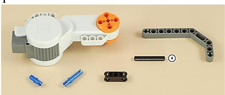
Примечание: числа, указанные рядом с осями и другими деталями, например, "4" рядом с мостов выше, относятся к длине оси или отверстия. Убедитесь, что Вы выбираете части правильной длины. Для измерения палочки, крючка и т.д., можно просто считать его количество отверстий. Для измерения оси, вы можете держать его рядом с палочкой и рассчитывать его длину по количеству отверстий в палочке.
