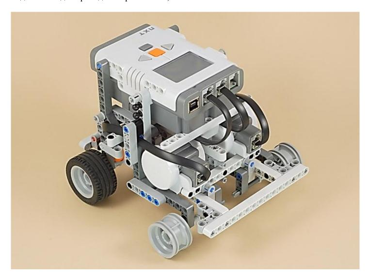
Завершаем постройку автомобиля базы нашего мультибота с колесами и «средним» передаточным отношением.
