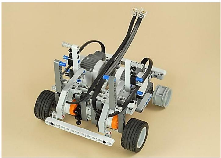
Два провода от двигателя прокладывайте вокруг задней части автомобиля, как показано выше. Затем сложите провода рядом, как показано ниже.
