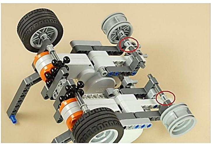
Обратите внимание, что передние колеса на Мультиботе не имеют резиновых шин. Это позволяет роботу легко повернуть на гладких поверхностях, сдвинув передние колеса из стороны в сторону. Только на задние колеса, которые приводятся в движение двигателями нужно устанавливать резиновые шинамы.
